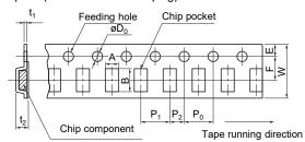
Unit : mm Code Α В W F Ε  $P_0$  $\phi D_0$  $t_1$  $t_2$ 1.5 1.55 ±0.20 2.35 ±0.20 8.0 ±0.2 3.50 ±0.05 1.75 ±0.10 2.00 ±0.05 0.6 1.5 EZJS max
